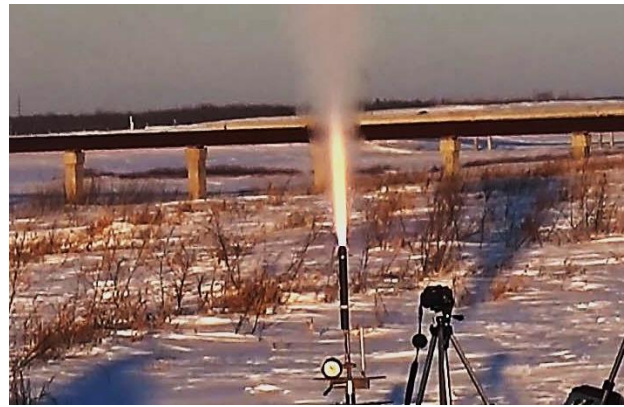
Figura 4: Ensayo experimental en estática del motor cohete Helios-X. Fecha: 13 de marzo de 2017 [4].
